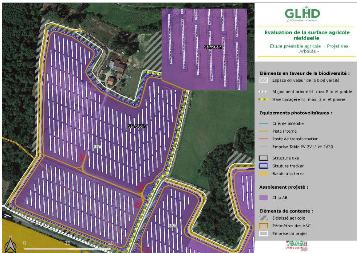
Carte 23 : Illustration du calcul de la surface résiduelle agricole à travers l'îlot 37a
